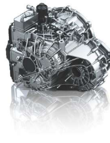
«Дымқыл» типті, қос іліністі, 9 сатылы робот беріліс қорабы
